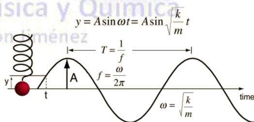
El movimiento oscilatorio de un cuerpo sobre una trayectoria recta es **armónico simple** cuando está sometido a la acción de una fuerza de atracción proporcional al vector de posición, con origen en su punto de equilibrio o centro de oscilación, y de sentido contrario.
