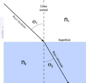
En la refracción de ondas se cumple la **ley de Snell**: La razón entre el seno del ángulo de incidencia y el seno del ángulo de refracción es, para dos medios dados, constante e igual a la razón de las velocidades con que se propaga la onda en ambos medios.
