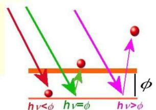
Esta expresión se conoce como **ecuación de Einstein del efecto fotoeléctrico**. Esto explica porque no aumenta la energía cinética de los electrones al incrementarse la intensidad de la luz. La energía cinética depende únicamente de la frecuencia de la luz incidente y de la frecuencia umbral. Un aumento de la intensidad solo supone un incremento del número de fotones que llegan a la superficie, con lo que es mayor el número de electrones arrancados pero no su energía cinética.
