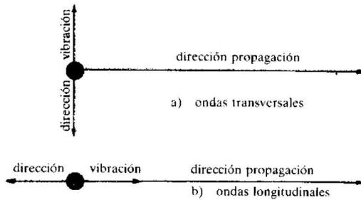
**Ondas longitudinales** son aquellas en las que las partículas vibran en la misma dirección que la propagación.
